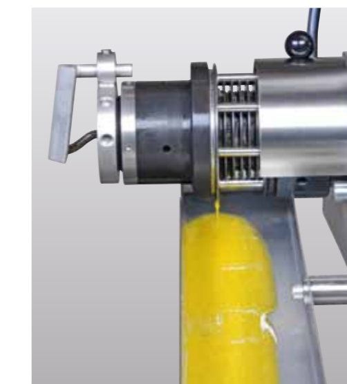
Presszylinder mit optimiertem Ölaustritt
